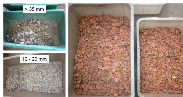
Рис. 6. Зразки відсортованих бетонних (сірих) і керамічних (червоних) заповнювачів
