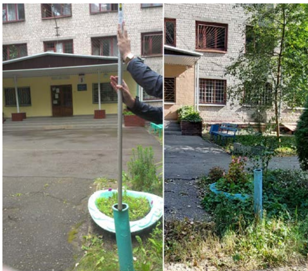
Рис. 3. Тимчасовий репер R_{p \text{ врем}} напроти головного входу у гуртожиток ХНАДУ № 3 (ліворуч – 2017 рік, праворуч – 2023 рік)
