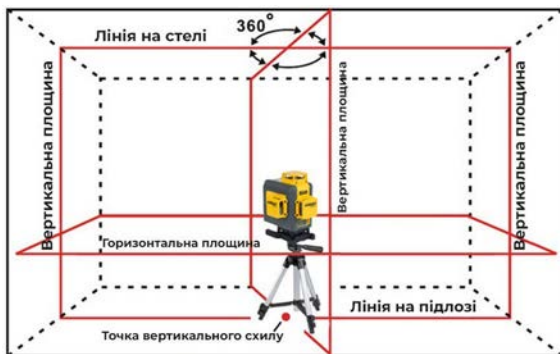
Рис. 6. Принцип роботи лазерного нівеліра [23]
