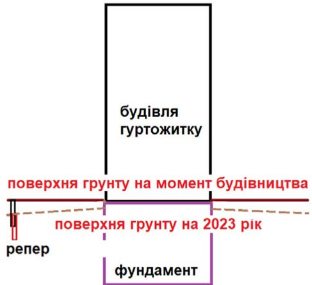
Рис. 15. Імовірна схема зміни місцеположення ґрунтового репера
